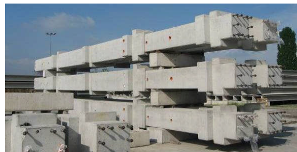
Figura 15. Stoccaggio pilastri prefabbricati
