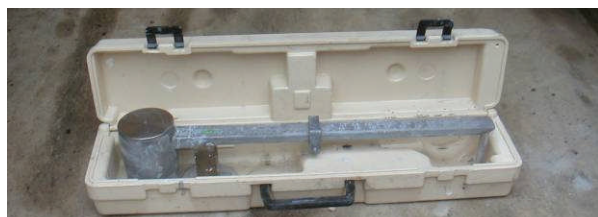
Figura 5. Bilancia tipo Baroid
