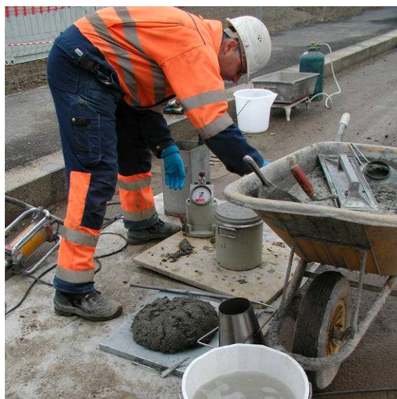
Figura 8. Controlli cls fresco per getto platea
