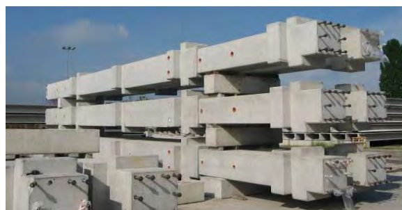
Figura 15. Stoccaggio pilastri prefabbricati
